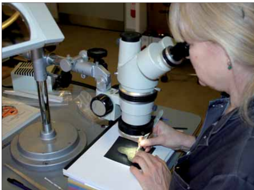
Fig. 17. Et trefliget spænde afrenses med skalpel under mikroskop. Foto: Jannie Amsgaard Ebsen
