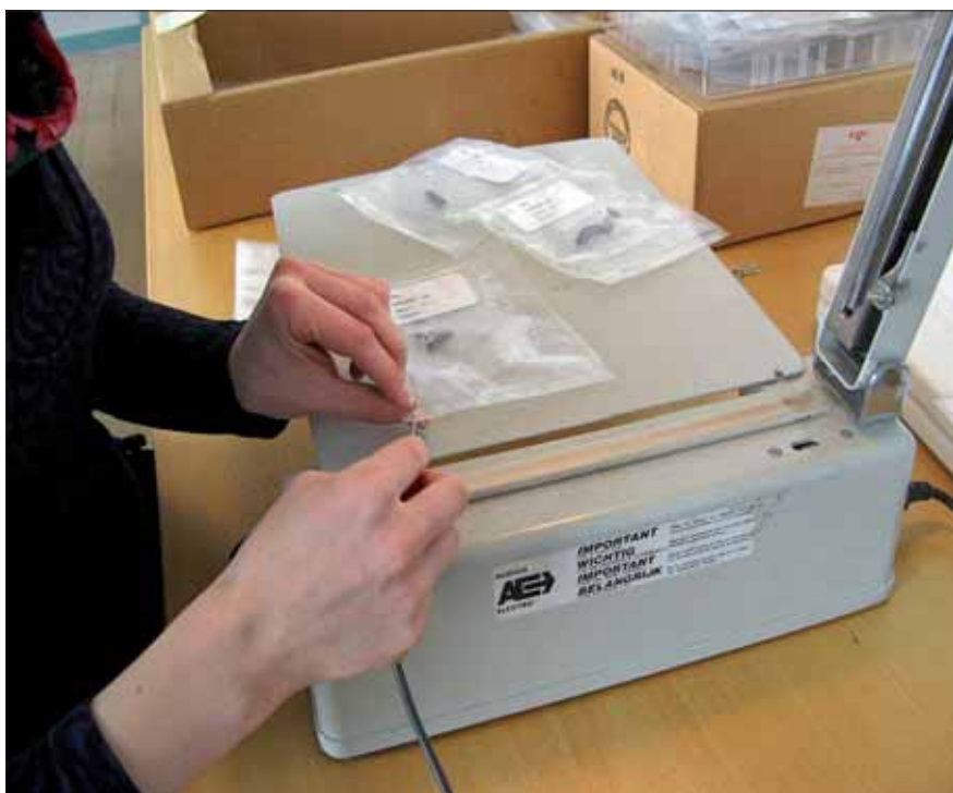
Fig. 16. Vakuumpakning af jerngenstande i lufttætte plastposer. Foto: Eva Salomonsen
