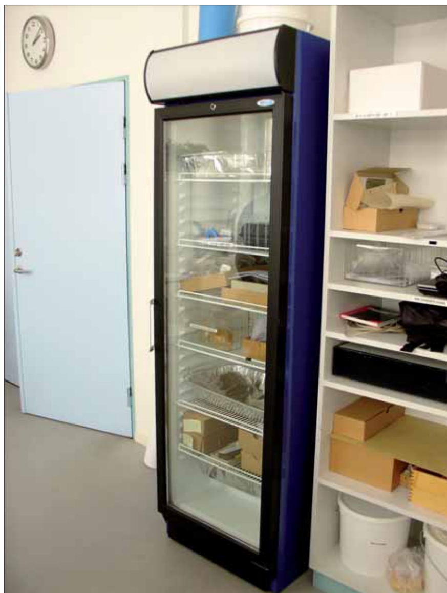
Fig. 14. Tørreskab fremstillet af et tætnet brugt kioskkøleskab med silicagel og et hygrometer til at overvåge den relative luftfugtighed på Nationalmuseet. Foto: Signe Nygaard
