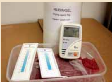
Silicagel, klimadatalogger og fugtigheds-indikatorsticks
