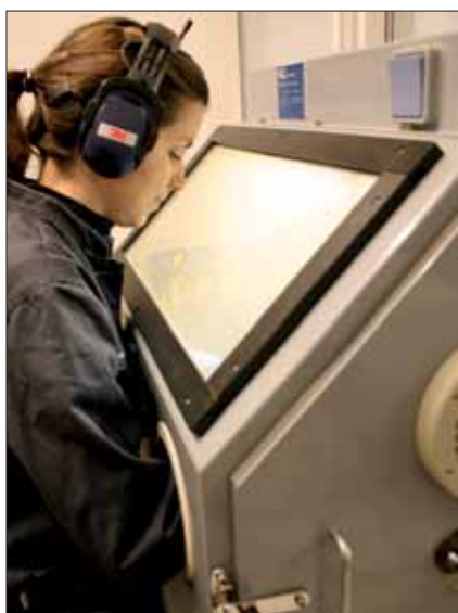
Fig. 12. Sandblæsning af arkæologiske jerngenstande på Odense Bys Museer. Foto: Jens Greegers Aagaard
