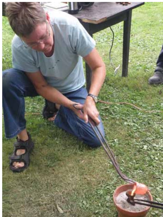
Fig.9. Den flydende bronze hældes i støbeformen
