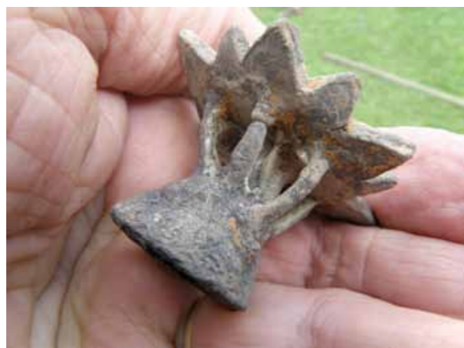
Fig.11 Færdigt bronzeemne med indløbskegle og fordelingskanaler
